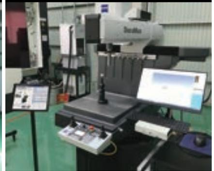
テクニカルセンターは、当社製品を実際に加工し、お客様に安心してご使用頂くことを目的としています。高精度マシニングセンター「V56i」(牧野フライス製作所)や小型CNC3次元座標測定機「DuraMax」(カールツァイス)を加工実験用の設備として導入し、恒温に保たれた空間で日々開発、検証を行なっています。また、自動車部品や農業機械メーカー様などから依頼を受けて試作したPCDDドリルや超硬ドリルでの加工の実証実験を行い、改良を重ねて性能を高め、ユーザー様それぞれのニーズに応えるスペックに上げていきます。
